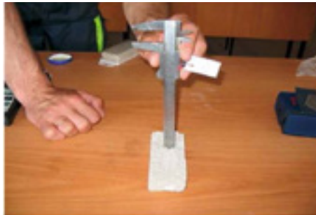
Контроль толщины слоя огнезащитных обмазок и толстослойных ОЗС с помощью штангенциркуля
