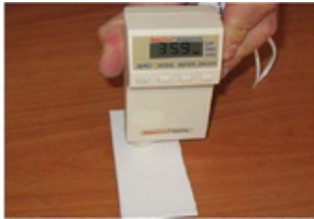
Контроль толщины сухого слоя краски с помощью магнитного толщиномера
