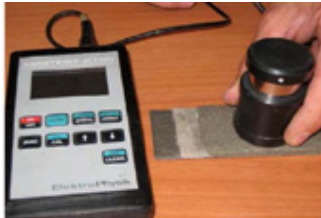
Контроль толщины сухого слоя краски с помощью магнитного толщиномера
